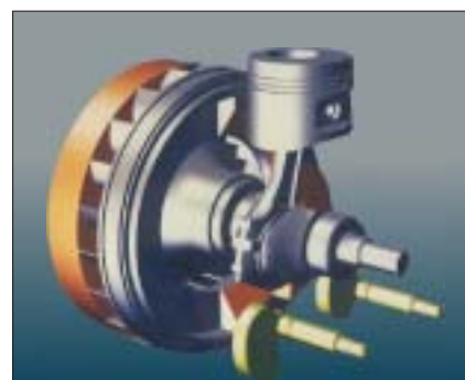
下死点后90°，振荡力=0 平衡块的力由平衡轴平衡。 飞轮外表面上的重量平衡力矩。
