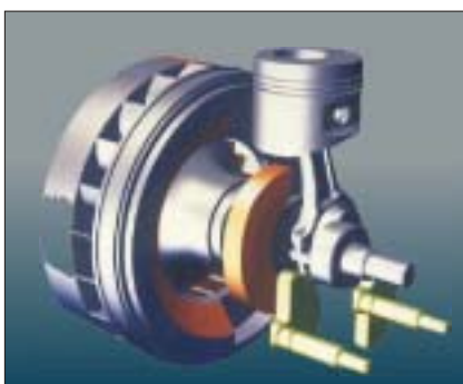
上死点后90°，振荡力=0 平衡块的力由平衡轴平衡。
